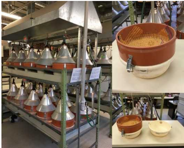
Abbildung 2: Kempson-Extraktor im Bodenlabor der UIBK. Mittels Hitze werden die Bodentiere aus den Proben getrieben und fallen in die in Kühlflüssigkeit stehenden Auffanggefäße.
