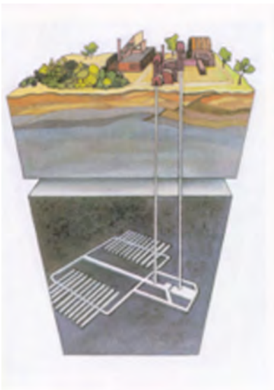
Abb. 1: Blockbild mit Zwischenlager, Abfallbehandlungsanlagen an der Erdoberfläche, unbekannter Geologie des tieferen Untergrundes, zwei Zugangsschächten und mehreren Endlagerkammern auf einer Einlagerungsebene; aus [Geobariera 2004],
