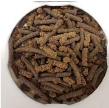
Abbildung 1. Ungleichmäßige Extrudate bei Zudosierung von ganzen Larven
