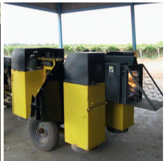
Mit der neuen TPC-Maschine wird heiße Luft auf die Pflanzen geblasen.
