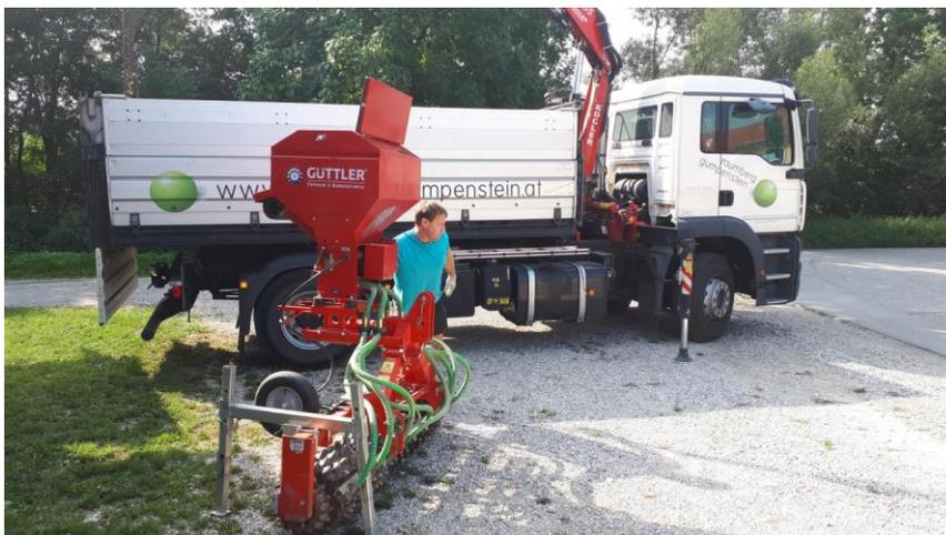
Abbildung 3: Güttlergerät mit Säeinrichtung und nachlaufender Profilwalze
